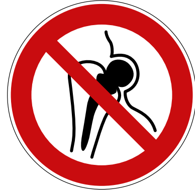
Abbildung 9.7 Standardmäßige Verbotsszeichen, die häufig im Zusammenhang mit elektromagnetischen Feldern angezeigt werden
