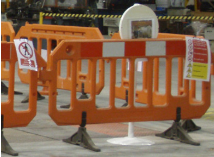
Abbildung 9.5 Zeitweilige Sperren und Warnzeichen zur Beschränkung des Zugangs zu starken Feldern, die von einer vorübergehend errichteten Anlage erzeugt werden
